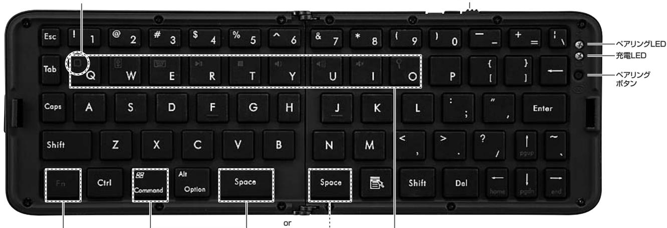
「Fn」キー: 「Fn」キーを押している間、赤色で表記されたショートカット機能が動作します。
