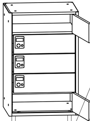
同梱してあるボルトとナットを使って各ボックスを結合します。
